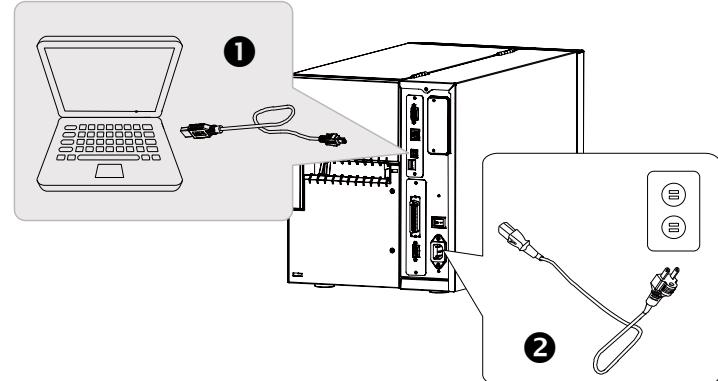
Turn on the Power/開啟電源/开启电源/電源を入れる/Включение принтера/Schalte den Strom an/Allumer l'appareil/Conectar la alimentación/Accendi il potere/تشغيل الطاقة
